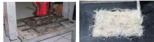
Gambar 3. Proses Komposit Serat Aren Dimasukkan Kedalam Cetakan Dan Dipress (Sumber: dokumentasi penulis)
