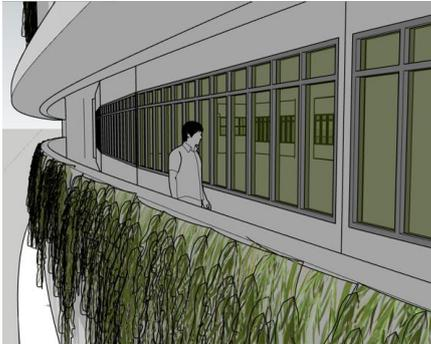
Gambar 5. Sun Shading dan Vegetasi pada Fasad
