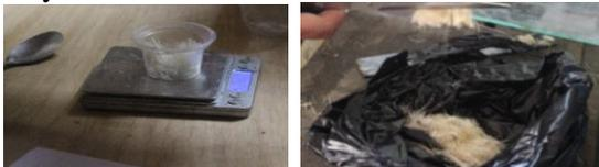
Gambar 2. Pemotongan Serat Aren Kemudian Ditimbang
