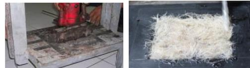
Gambar 3. Proses Komposit Serat Aren Dimasukkan Kedalam Cetakan Dan Dipress
