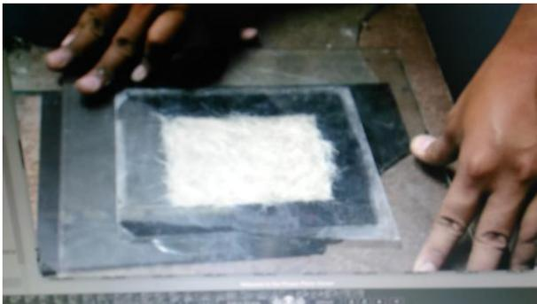
Gambar .2 Proses Pembuatan Sampel Untuk Uji Bending Bahan Ilalang
