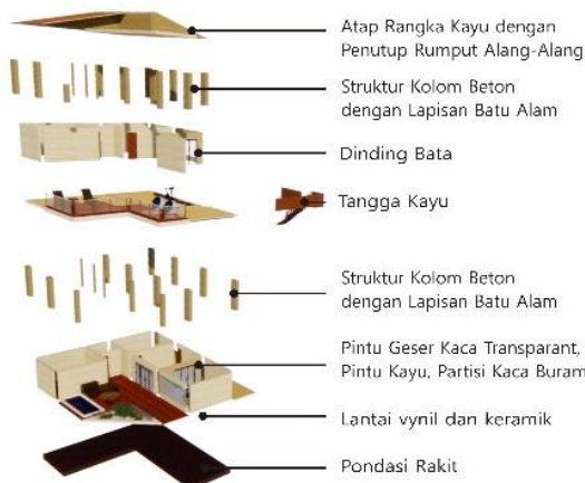
Gambar 20. Aksonometri Struktur Cottage
